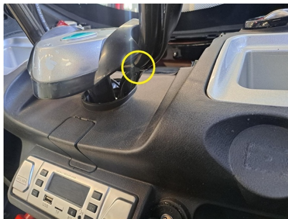
Katko kaasukahvan johtoa kiinni pitävät nippusiteet. (sivuleikkurit).
